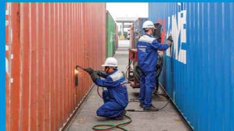
Các dịch vụ phụ trợ: giám định và sửa chữa container, PTI, đóng rút hàng hóa. Ancillary services: inspection and repair of containers, PTI, Cargo stuffing, and unstuffing.
